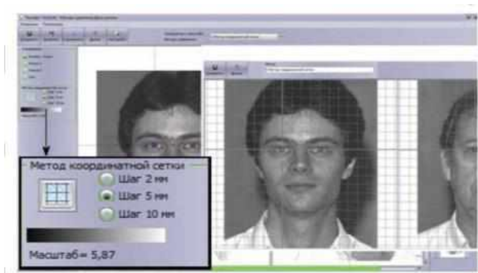
Рис. 2. Рабочее окно демо-версии программы «VisoSoft» при выполнении метода наложения координатной сетки (стрелкой с рамкой черного цвета вынесено увеличенное изображение настроек сетки)
